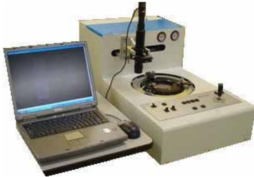
図3 アライメント装置 Model WMA-400
